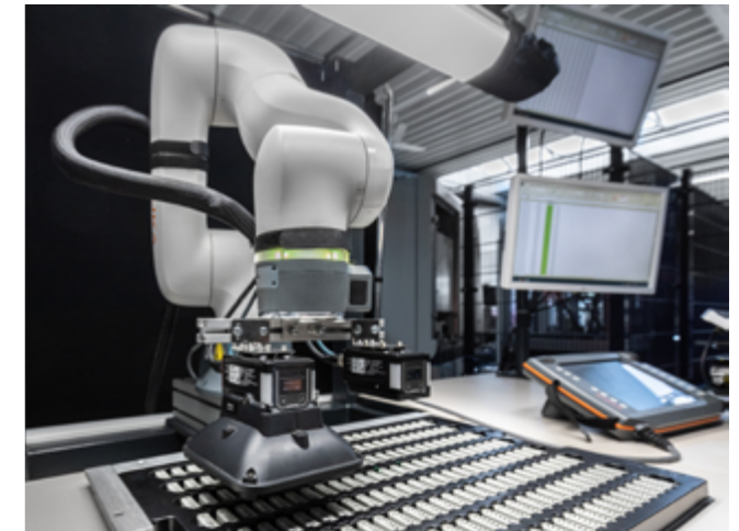
Mit Kameras prüft ein LBR iisy Cobot in Verbindung mit dem iiQKA.OS Betriebssystem die Qualität in der Kunststoffindustrie.
