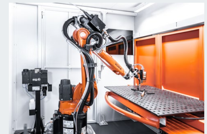
Der KR CYBERTECH nano bei einer Schweißapplikation
