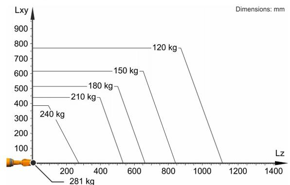
Der KR 210 R3100-2 F ist ausgelegt für eine Nenn-Traglast von 210 kg, um die Performance und Dynamik des Roboters optimal zu nutzen. Nur wenn die Lage des Massenschwerpunkts 0 mm und eine für den Lastfall optimierte Zusatzlast angebracht sind, gilt die maximale Traglast von 281 kg. Der spezifische Lastfall muss mit KUKA.Load oder KUKA Compose überprüft werden. Für weitere Beratung steht der KUKA Support zur Verfügung.
