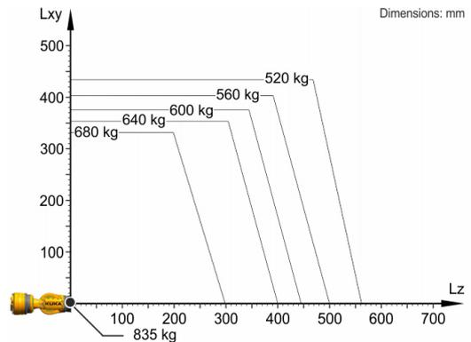
KR 640 R2800-2 HI est conçu pour une charge nominale de 640 kg pour une utilisation optimale de la performance et de la dynamique du robot. Avec des distances de charge réduites et des charges supplémentaires avantageuses, il est possible d'appliquer une charge maximale allant jusqu'à 835 kg. Les cas de charge spécifiques doivent être contrôlés avec KUKA Load. Le SAV KUKA est à votre disposition pour vous conseiller.
