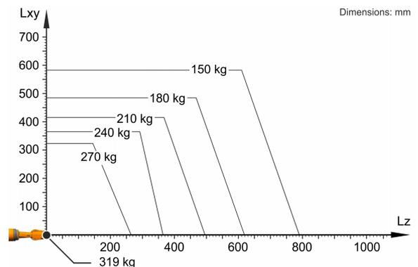
Der KR 240 R2900-2 F ist ausgelegt für eine Nenn-Traglast von 240 kg, um die Performance und Dynamik des Roboters optimal zu nutzen. Nur wenn die Lage des Massenschwerpunkts 0 mm und eine für den Lastfall optimierte Zusatzlast angebracht sind, gilt die maximale Traglast von 319 kg. Der spezifische Lastfall muss mit KUKA.Load oder KUKA Compose überprüft werden. Für weitere Beratung steht der KUKA Support zur Verfügung.
