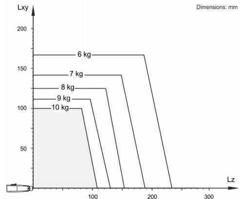
O KR 10 R900 CR está configurado para uma capacidade de carga nominal de 5 kg, para usar de forma ideal o desempenho e a dinâmica do robô. Somente se a posição do centro de gravidade da massa for 0 mm e estiver colocada uma carga adicional otimizada para o caso de carga, é válida a capacidade de carga máxima de 10 kg. O caso de carga específico deve ser controlado com KUKA.Load ou KUKA Compose. O Suporte KUKA está à sua disposição para maiores detalhes.
