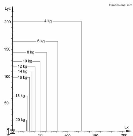
KR 20 R1200 Z450 está configurado para una carga nominal de 10 kg para aprovechar de forma óptima el rendimiento y la dinámica del manipulador. Con intervalos de carga reducidos también se pueden aplicar cargas superiores hasta la capacidad de carga máxima. La situación de carga concreta debe controlarse con KUKA.Load. Para un asesoramiento individual, póngase en contacto con KUKA Support.
