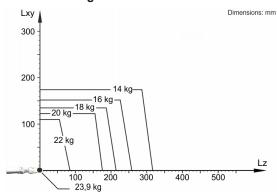
KR 20 R1810 HO est conçu pour une charge nominale de 20 kg pour une utilisation optimale de la performance et de la dynamique du robot. Seulement si la position du centre de gravité = 0 mm et une charge supplémentaire optimisée pour le cas de charge sont attachées, la charge maximale de 23,9 kg s'applique. Les cas de charge spécifiques doivent être contrôlés avec KUKA Load ou KUKA Compose. Notre assistance technique KUKA Support est à votre disposition pour vous conseiller.
