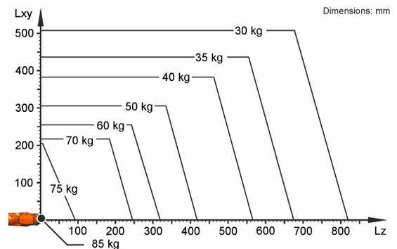
KR 70 R2100 F está configurado para una carga nominal de 70 kg para aprovechar de forma óptima el rendimiento y la dinámica del robot. Con distancias de carga reducidas y cargas adicionales favorables, puede instalarse una carga máxima de hasta 85 kg. La situación de carga concreta debe controlarse con KUKA Load. Para un asesoramiento individual, póngase en contacto con KUKA Service.
