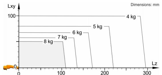
Le KR 8 R1620 arc HW est conçu pour une charge nominale de 8 kg pour une utilisation optimale de la performance et de la dynamique du robot. En réduisant les distances de charges, il est également possible d'utiliser des charges plus élevées jusqu'à la charge maximum. Les cas de charge spécifiques doivent être contrôlés avec KUKA.Load. Notre assistance technique est à votre disposition pour vous conseiller.
