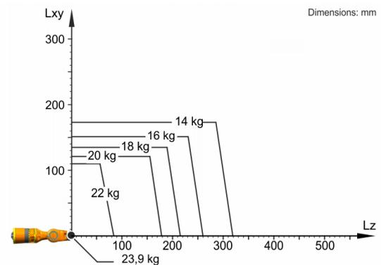
KR 20 R1810-2 está configurado para una carga nominal de 20 kg para aprovechar de forma óptima el rendimiento y la dinámica del robot. Solo si la posición del centro de gravedad de la masa es de 0 mm y se ha aplicado una carga adicional optimizada para la situación de carga, se aplica la carga máxima de 23,9 kg. La situación de carga específica debe comprobarse con KUKA.Load o KUKA Compose. Para un asesoramiento individual, póngase en contacto con KUKA Support.
