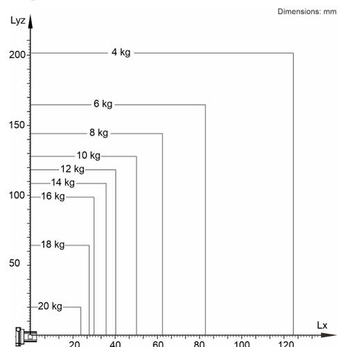
Der KR 20 R800 Z390 CR ist für eine Nenn-Traglast von 10 kg ausgelegt, um die Performance und Dynamik des Manipulators optimal zu nutzen. Mit reduzierten Lastabständen können auch höhere Lasten bis zur maximalen Traglast zur Anwendung kommen. Der spezifische Lastfall muss mit KUKA.Load überprüft werden. Für weitere Beratung steht der KUKA Support zur Verfügung.
