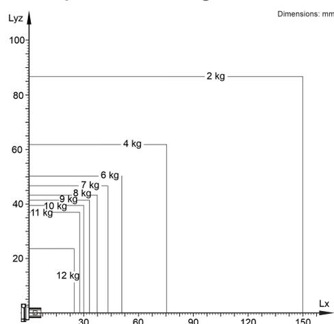
O KR 12 R850 Z400 está configurado para uma capacidade de carga nominal de 6 kg, para usar de forma ideal o desempenho e a dinâmica do manipulador. Com distâncias de carga reduzidas podem ser aplicadas também cargas maiores até a capacidade de carga máxima. O caso de carga específico deve ser verificado com KUKA.Load. O Suporte KUKA está à sua disposição para maiores detalhes.
