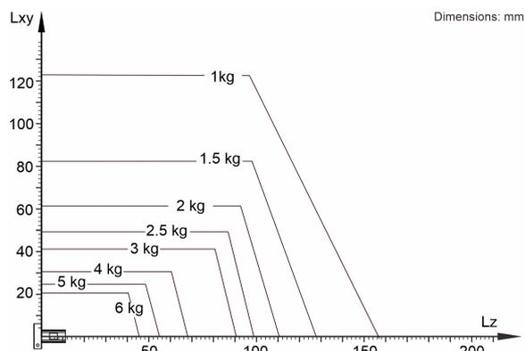
O KR 3 D1200 HM está configurado para uma capacidade de carga nominal de 3 kg, para usar de forma ideal o desempenho e a dinâmica do robô. Com distâncias de carga reduzidas e cargas adicionais favoráveis, pode ser instalada uma capacidade de carga máxima de até 6 kg. O caso de carga específico deve ser verificado com KUKA Load. O KUKA Service está à sua disposição para mais consultoria.
