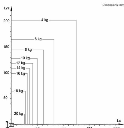
Il KR 20 R1200 Z450 è progettato per una portata nominale di 10 kg in grado di sfruttare al meglio le prestazioni e la dinamicità del manipolatore. Con distanze di carico ridotte possono essere utilizzati anche carichi maggiori fino al carico portante massimo. La situazione di carico specifica deve essere verificata con KUKA.Load. Per un'ulteriore consulenza il servizio di assistenza KUKA rimane a vostra disposizione.
