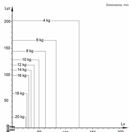
Der KR 20 R1200 Z450 ist für eine Nenn-Traglast von 10 kg ausgelegt, um die Performance und Dynamik des Manipulators optimal zu nutzen. Mit reduzierten Lastabständen können auch höhere Lasten bis zur maximalen Traglast zur Anwendung kommen. Der spezifische Lastfall muss mit KUKA.Load überprüft werden. Für weitere Beratung steht der KUKA Support zur Verfügung.
