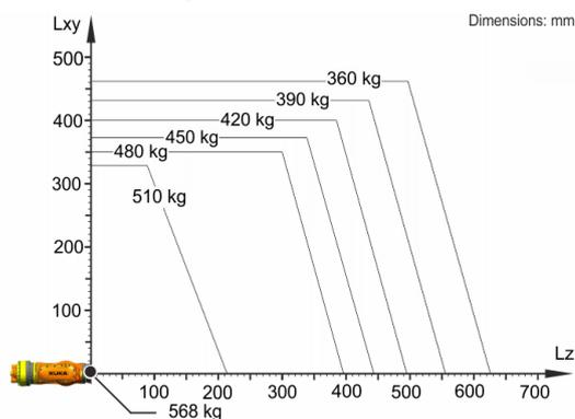
KR 480 R3330 MT est conçu pour une charge nominale de 480 kg pour une utilisation optimale de la performance et de la dynamique du robot. Seulement si la position du centre de gravité = 0 mm et une charge supplémentaire optimisée pour le cas de charge sont attachées, la charge maximale de 568 kg s'applique. Les cas de charge spécifiques doivent être contrôlés avec KUKA Load ou KUKA Compose. Notre assistance technique KUKA Support est à votre disposition pour vous conseiller.
