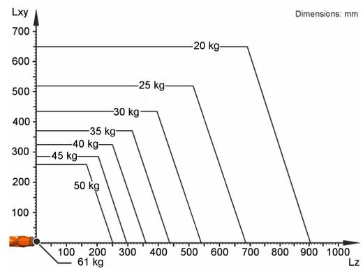
Der KR 50 R2100 HO ist ausgelegt für eine Nenn-Traglast von 50 kg, um die Performance und Dynamik des Roboters optimal zu nutzen. Mit reduzierten Lastabständen und günstigen Zusatzlasten, kann eine maximale Traglast bis zu 61 kg angebracht werden. Der spezifische Lastfall muss mit KUKA Load überprüft werden. Für weitere Beratung steht der KUKA Service zur Verfügung.
