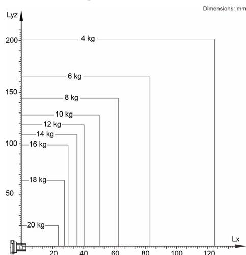
Le KR 20 R800 Z390 CR est conçu pour une charge nominale de 10 kg pour une utilisation optimale de la performance et de la dynamique du manipulateur. En réduisant les distances de charges, il est également possible d'utiliser des charges plus élevées jusqu'à la charge maximum. Les cas de charge spécifiques doivent être contrôlés avec KUKA.Load. Notre assistance technique KUKA Support est à votre disposition pour vous conseiller.
