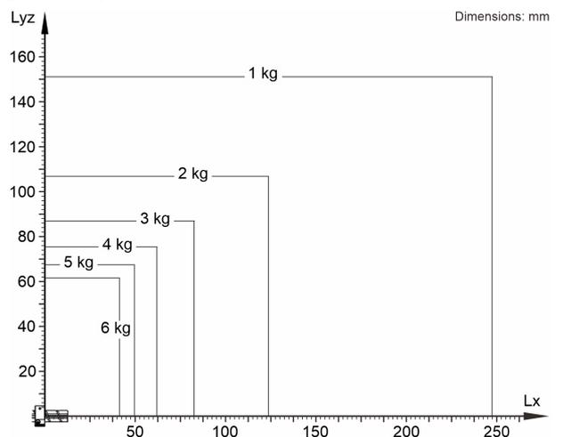
Der KR 6 R700 Z200 ist für eine Nenn-Traglast von 3 kg ausgelegt, um die Performance und Dynamik des Manipulators optimal zu nutzen. Mit reduzierten Lastabständen können auch höhere Lasten bis zur maximalen Traglast zur Anwendung kommen. Der spezifische Lastfall muss mit KUKA.Load überprüft werden. Für weitere Beratung steht der KUKA Support zur Verfügung.
