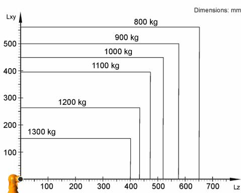
KR 1000 1300 titan PA-F est conçu pour une charge nominale de 1300 kg pour une utilisation optimale de la performance et de la dynamique du robot. Avec des distances de charge réduites et des charges supplémentaires avantageuses, il est possible d'appliquer une charge maximale allant jusqu'à 1300 kg. Les cas de charge spécifiques doivent être contrôlés avec KUKA Load. Le SAV KUKA est à votre disposition pour vous conseiller.
