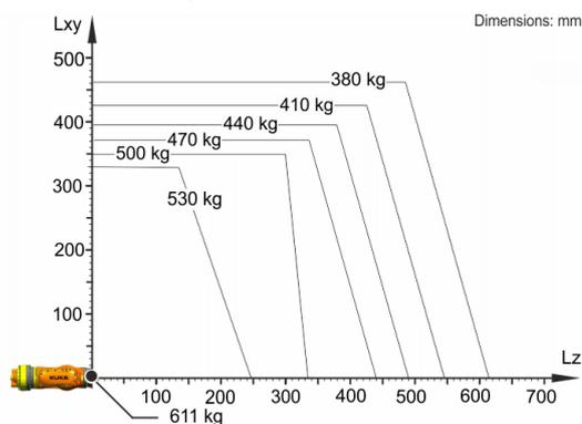
KR 500 R2830 MT est conçu pour une charge nominale de 500 kg pour une utilisation optimale de la performance et de la dynamique du robot. Seulement si la position du centre de gravité = 0 mm et une charge supplémentaire optimisée pour le cas de charge sont attachées, la charge maximale de 611 kg s'applique. Les cas de charge spécifiques doivent être contrôlés avec KUKA Load ou KUKA Compose. Notre assistance technique KUKA Support est à votre disposition pour vous conseiller.
