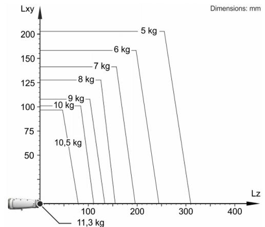
KR 10 R900-2 は、ロボットの性能とダイナミクスを最適に使用するため、10 kg の公称可搬重量用に設計されています。負荷間隔の短縮と有利な追加荷重により、最大 11.3 kg の可搬重量が取り扱い可能です。特定の荷重のケースでは、KUKA Load で検証が必要です。その他のアドバイスに関しては、KUKA サービスにお気軽にお問い合わせください。
