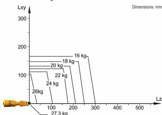
KR 22 R1610-2 est conçu pour une charge nominale de 22 kg pour une utilisation optimale de la performance et de la dynamique du robot. Seulement si la position du centre de gravité = 0 mm et une charge supplémentaire optimisée pour le cas de charge sont attachées, la charge maximale de 27,3 kg s'applique. Les cas de charge spécifiques doivent être contrôlés avec KUKA Load ou KUKA Compose. Notre assistance technique KUKA Support est à votre disposition pour vous conseiller.
