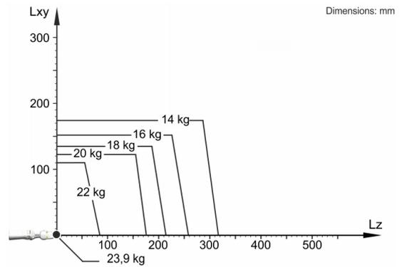
O KR 20 R1810 CR está configurado para uma capacidade de carga nominal de 20 kg, para usar de forma ideal o desempenho e a dinâmica do robô. Somente se a posição do centro de gravidade da massa for 0 mm e estiver colocada uma carga adicional otimizada para o caso de carga, é válida a capacidade de carga máxima de 23,9 kg. O caso de carga específico deve ser controlado com KUKA.Load ou KUKA.Compose. O Suporte KUKA está à sua disposição para maiores detalhes.
