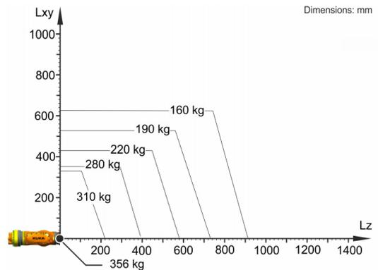
Der KR 280 R3080 F ist ausgelegt für eine Nenn-Traglast von 280 kg um die Performance und Dynamik des Roboters optimal zu nutzen. Mit reduzierten Lastabständen können auch höhere Lasten bis zur Maximalen Traglast zur Anwendung kommen. Der spezifische Lastfall muss mit KUKA.Load überprüft werden. Für weitere Beratung steht der KUKA Support zur Verfügung.
