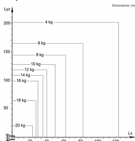
Il KR 20 R1200 Z390 CR è progettato per una portata nominale di 10 kg in grado di sfruttare al meglio le prestazioni e la dinamicità del manipolatore. Con distanze di carico ridotte possono essere utilizzati anche carichi maggiori fino al carico portante massimo. La situazione di carico specifica deve essere verificata con KUKA.Load. Per un'ulteriore consulenza il servizio di assistenza KUKA rimane a vostra disposizione.
