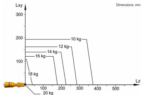
Der KR 16 R1610-2 ist ausgelegt für eine Nenn-Traglast von 16 kg, um die Performance und Dynamik des Roboters optimal zu nutzen. Mit reduzierten Lastabständen und günstigen Zusatzlasten, kann eine maximale Traglast bis zu 20 kg angebracht werden. Der spezifische Lastfall muss mit KUKA Load überprüft werden. Für weitere Beratung steht der KUKA Service zur Verfügung.
