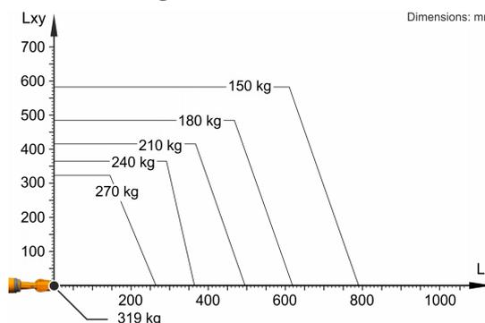
KR 240 R2900-2 F est conçu pour une charge nominale de 240 kg pour une utilisation optimale de la performance et de la dynamique du robot. Seulement si la position du centre de gravité = 0 mm et une charge supplémentaire optimisée pour le cas de charge sont attachées, la charge maximale de 319 kg s'applique. Les cas de charge spécifiques doivent être contrôlés avec KUKA Load ou KUKA Compose. Notre assistance technique KUKA Support est à votre disposition pour vous conseiller.
