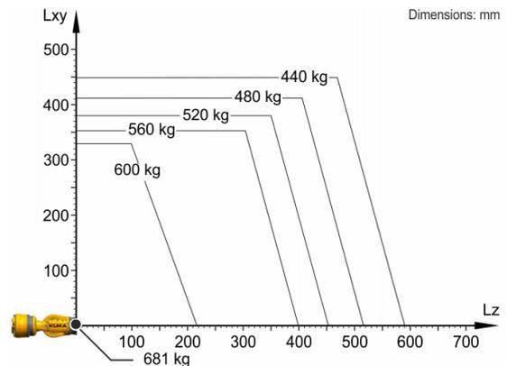
KR 560 R3100-2 está configurado para una carga nominal de 560 kg para aprovechar de forma óptima el rendimiento y la dinámica del robot. Con distancias de carga reducidas y cargas adicionales favorables, puede instalarse una carga máxima de hasta 681 kg. La situación de carga concreta debe controlarse con KUKA Load. Para un asesoramiento individual, póngase en contacto con KUKA Service.
