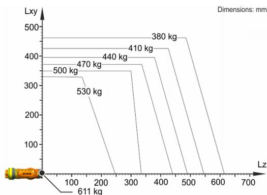
O KR 500 R2830 MT está configurado para uma capacidade de carga nominal de 500 kg, para usar de forma ideal o desempenho e a dinâmica do robô. Somente se a posição do centro de gravidade da massa for 0 mm e estiver colocada uma carga adicional otimizada para o caso de carga, é válida a capacidade de carga máxima de 611 kg. O caso de carga específico deve ser controlado com KUKA.Load ou KUKA Compose. O Suporte KUKA está à sua disposição para maiores detalhes.
