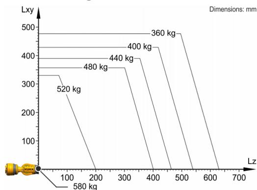
KR 480 R3700-2 est conçu pour une charge nominale de 480 kg pour une utilisation optimale de la performance et de la dynamique du robot. Avec des distances de charge réduites et des charges supplémentaires avantageuses, il est possible d'appliquer une charge maximale allant jusqu'à 580 kg. Les cas de charge spécifiques doivent être contrôlés avec KUKA Load. Le SAV KUKA est à votre disposition pour vous conseiller.
