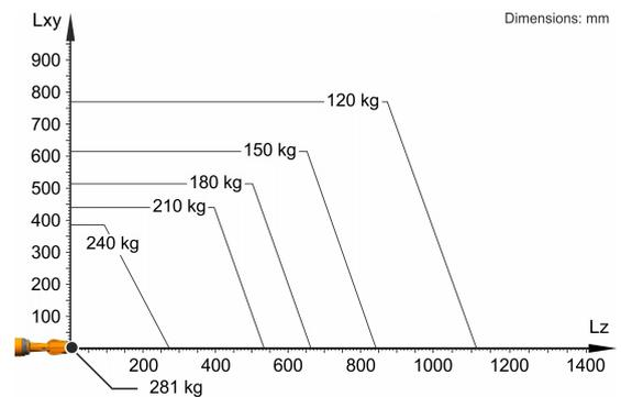
KR 210 R3100-2 está configurado para una carga nominal de 210 kg para aprovechar de forma óptima el rendimiento y la dinámica del robot. Solo si la posición del centro de gravedad de la masa es de 0 mm y se ha aplicado una carga adicional optimizada para la situación de carga, se aplica la carga máxima de 281 kg. La situación de carga específica debe comprobarse con KUKA.Load o KUKA Compose. Para un asesoramiento individual, póngase en contacto con KUKA Support.
