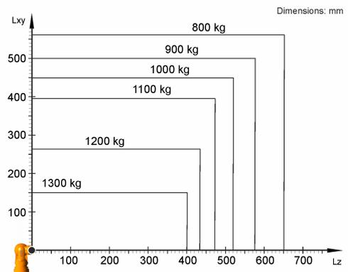
KR 1000 1300 titan PA está configurado para una carga nominal de 1300 kg para aprovechar de forma óptima el rendimiento y la dinámica del robot. Con distancias de carga reducidas y cargas adicionales favorables, puede instalarse una carga máxima de hasta 1300 kg. La situación de carga concreta debe controlarse con KUKA Load. Para un asesoramiento individual, póngase en contacto con KUKA Service.
