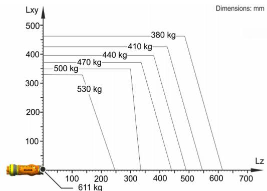
KR 500 R2830 MT-F está configurado para una carga nominal de 500 kg para aprovechar de forma óptima el rendimiento y la dinámica del robot. Solo si la posición del centro de gravedad de la masa es de 0 mm y se ha aplicado una carga adicional optimizada para la situación de carga, se aplica la carga máxima de 611 kg. La situación de carga específica debe comprobarse con KUKA.Load o KUKA Compose. Para un asesoramiento individual, póngase en contacto con KUKA Support.
