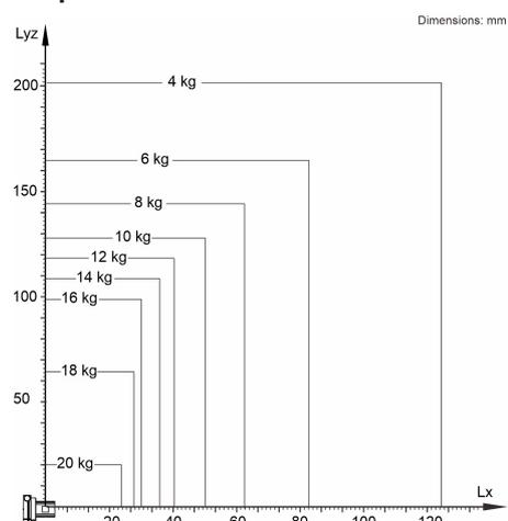
Il KR 20 R800 Z390 CR è progettato per una portata nominale di 10 kg in grado di sfruttare al meglio le prestazioni e la dinamicità del manipolatore. Con distanze di carico ridotte possono essere utilizzati anche carichi maggiori fino al carico portante massimo. La situazione di carico specifica deve essere verificata con KUKA.Load. Per un'ulteriore consulenza il servizio di assistenza KUKA rimane a vostra disposizione.
