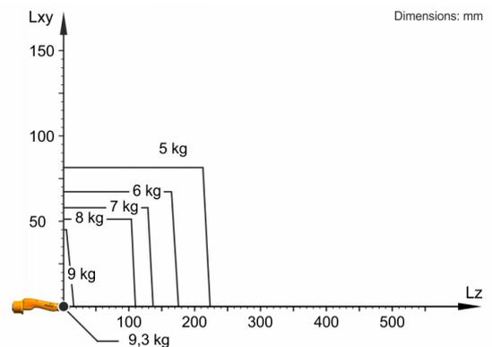
KR 8 R2100-2 arc HW est conçu pour une charge nominale de 8 kg pour une utilisation optimale de la performance et de la dynamique du robot. Seulement si la position du centre de gravité = 0 mm et une charge supplémentaire optimisée pour le cas de charge sont attachées, la charge maximale de 9,3 kg s'applique. Les cas de charge spécifiques doivent être contrôlés avec KUKA Load ou KUKA Compose. Notre assistance technique KUKA Support est à votre disposition pour vous conseiller.
