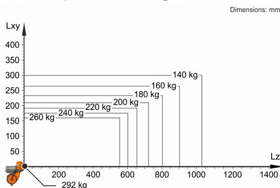
O KR 240 R3200-2 PA está configurado para uma capacidade de carga nominal de 240 kg, para usar de forma ideal o desempenho e a dinâmica do robô. Com distâncias de carga reduzidas e cargas adicionais favoráveis, pode ser instalada uma capacidade de carga máxima de até 292 kg. O caso de carga específico deve ser verificado com KUKA Load. O KUKA Service está à sua disposição para mais consultoria.
