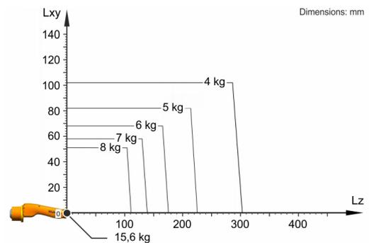
Il KR 8 R1640-2 arc HW è progettato per una portata nominale di 8 kg in grado di sfruttare al meglio le prestazioni e la dinamicità del robot. Con distanze di carico ridotte e carichi addizionali favorevoli è possibile applicare un carico utile massimo di 10,7 kg. La situazione di carico specifica deve essere verificata con KUKA Load. Per un'ulteriore consulenza il servizio di assistenza KUKA rimane a vostra disposizione.
