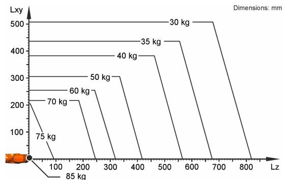
O KR 70 R2100 F está configurado para uma capacidade de carga nominal de 70 kg, para usar de forma ideal o desempenho e a dinâmica do robô. Com distâncias de carga reduzidas e cargas adicionais favoráveis, pode ser instalada uma capacidade de carga máxima de até 85 kg. O caso de carga específico deve ser verificado com KUKA Load. O KUKA Service está à sua disposição para mais consultoria.
