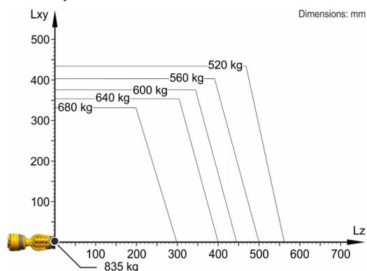
Il KR 640 R2800-2 HI è progettato per una portata nominale di 640 kg in grado di sfruttare al meglio le prestazioni e la dinamicità del robot. Con distanze di carico ridotte e carichi addizionali favorevoli è possibile applicare un carico utile massimo di 835 kg. La situazione di carico specifica deve essere verificata con KUKA Load. Per un'ulteriore consulenza il servizio di assistenza KUKA rimane a vostra disposizione.
