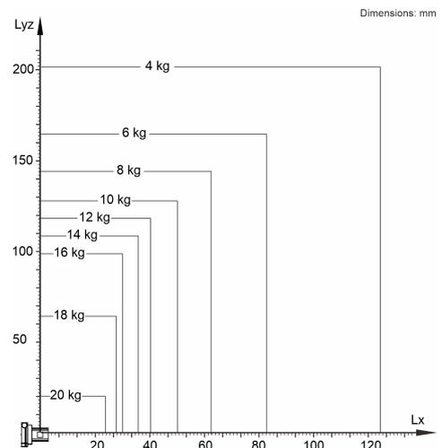
KR 20 R800 Z390 CR está configurado para una carga nominal de 10 kg para aprovechar de forma óptima el rendimiento y la dinámica del manipulador. Con intervalos de carga reducidos también se pueden aplicar cargas superiores hasta la capacidad de carga máxima. La situación de carga concreta debe controlarse con KUKA.Load. Para un asesoramiento individual, póngase en contacto con KUKA Support.
