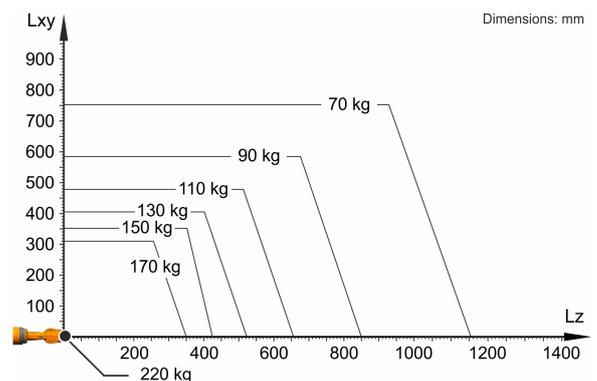
KR 150 R3100-2 F está configurado para una carga nominal de 150 kg para aprovechar de forma óptima el rendimiento y la dinámica del robot. Solo si la posición del centro de gravedad de la masa es de 0 mm y se ha aplicado una carga adicional optimizada para la situación de carga, se aplica la carga máxima de 220 kg. La situación de carga específica debe comprobarse con KUKA.Load o KUKA Compose. Para un asesoramiento individual, póngase en contacto con KUKA Support.
