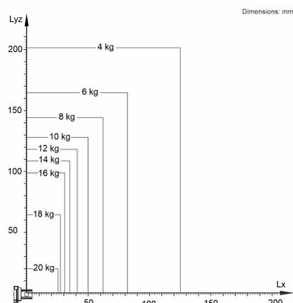
Il KR 20 R800 Z450 è progettato per una portata nominale di 10 kg in grado di sfruttare al meglio le prestazioni e la dinamicità del manipolatore. Con distanze di carico ridotte possono essere utilizzati anche carichi maggiori fino al carico portante massimo. La situazione di carico specifica deve essere verificata con KUKA.Load. Per un'ulteriore consulenza il servizio di assistenza KUKA rimane a vostra disposizione.
