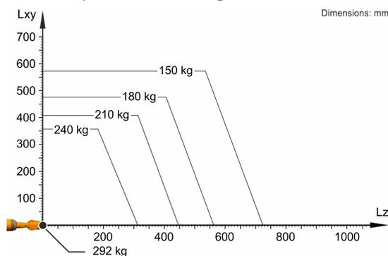
O KR 240 R2900-2 C está configurado para uma capacidade de carga nominal de 240 kg, para usar de forma ideal o desempenho e a dinâmica do robô. Somente se a posição do centro de gravidade da massa for 0 mm e estiver colocada uma carga adicional otimizada para o caso de carga, é válida a capacidade de carga máxima de 292 kg. O caso de carga específico deve ser controlado com KUKA.Load ou KUKA Compose. O Suporte KUKA está à sua disposição para maiores detalhes.
