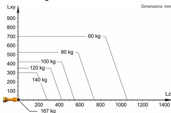
KR 120 R2700-2 F está configurado para una carga nominal de 120 kg para aprovechar de forma óptima el rendimiento y la dinámica del robot. Solo si la posición del centro de gravedad de la masa es de 0 mm y se ha aplicado una carga adicional optimizada para la situación de carga, se aplica la carga máxima de 167 kg. La situación de carga específica debe comprobarse con KUKA.Load o KUKA Composite. Para un asesoramiento individual, póngase en contacto con KUKA Support.
