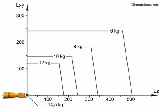
KR 12 R1810-2 está configurado para una carga nominal de 12 kg para aprovechar de forma óptima el rendimiento y la dinámica del robot. Solo si la posición del centro de gravedad de la masa es de 0 mm y se ha aplicado una carga adicional optimizada para la situación de carga, se aplica la carga máxima de 14,5 kg. La situación de carga específica debe comprobarse con KUKA.Load o KUKA Compose. Para un asesoramiento individual, póngase en contacto con KUKA Support.
