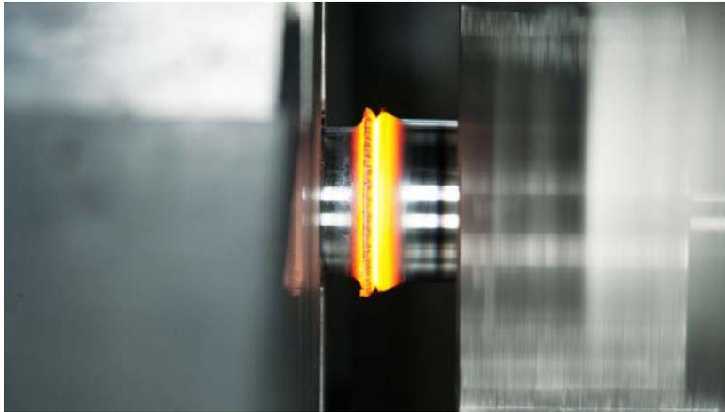
**Bild Reibschweißen:** Beim Reibschweißen nutzt man die durch Reibung entstehende Wärme. Dabei werden Teile rotierend relativ zueinander bewegt, wobei sie sich an den Kontaktflächen berühren. Ist das Material bis zur Plastifizierung erwärmt, werden die Teile positioniert und mit hohem Druck aufeinander gedrückt.
