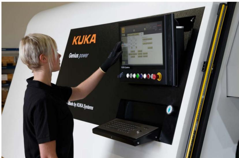
**Bild S0778-011:** Alle Prozessdaten werden von der KUKA PCD (Process Control and Documentation)-Steuerung numerisch überwacht und elektronisch archiviert und stehen daher für weitere Analysemöglichkeiten z.B. in Cloud-Systemen zur Verfügung.
